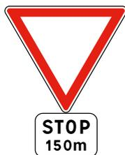
**AB5\*** Arrêt à l'intersection. Signal avancé du AB4
