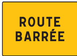
KC1 21P : route barrée
