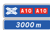
D74a - Panneau de présignalisation complémentaire de bifurcation autoroutière comportant des numéros d'autoroutes
