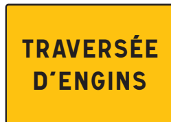
KC1 TE : traversée d'engins
