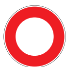
BK0 Circulation interdite à tout véhicule dans les 2 sens
