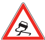
A4 Chaussée particulièrement glissante
