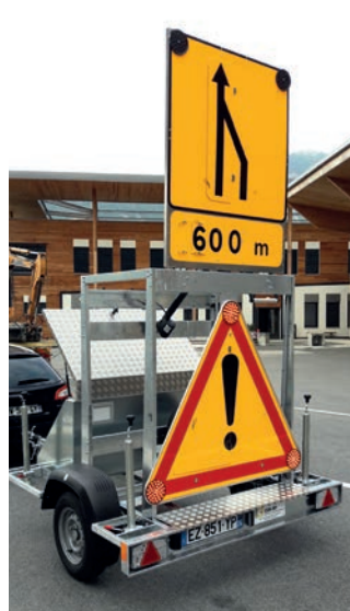
Remorque de pré-signalisation FLR : PTAC 750KG
