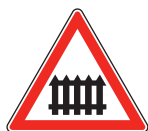
A7 Passage à niveau à barrières à fonctionnement manuel
