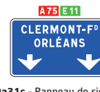
Da31c - Panneau de signalisation avancée d'affectation de voies de bifurcation autoroutière
