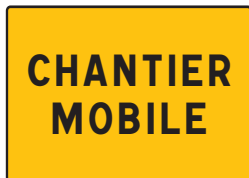
KC1 CM : chantier mobile
