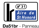
Da51br - Panneau d'avertissement de sortie donnant également accès à une aire de service ou de repos, avec affectation de voie
