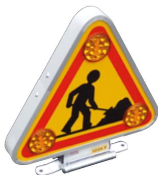
Caisson triangulaire ép. 52 mm, faces 2 tôles d'aluminium serties dans un profilé aluminium anodisé. 3 feux clignotants synchronisés double faces Ø 110 mm. Centrale 12 ou 24 volts (à préciser à la commande).
