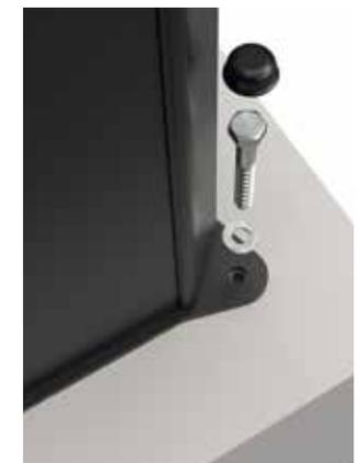
Fixation par 4 chevilles Ø 10 mm à l'aide du gabarit de pose fourni et 4 tirefonds Ø 8 x 60 mm dans un massif béton de 350 x 350 x 350 mm
