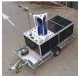
Éclairage de chantier mobile Greenlight Premium à énergie solaire et éolien, entièrement autonome
