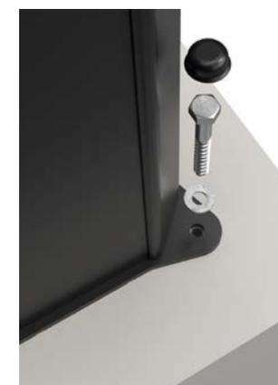
Fixation par 4 chevilles  $\varnothing$  10 mm à l'aide du gabarit de pose fourni et 4 tirefonds  $\varnothing$  8 x 60 mm dans un massif béton de 350 x 350 x 350 mm
